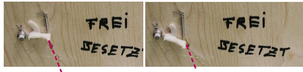
Zeigerapparat (außen) die vom Nylonfaden nach unten gezogen wird. Linkes Bild - ohne Auslösung, rechtes Bild - mit Auslösung durch Gewicht. Eine Feder hält den Anzeiger im Neutralzustand (links) in etwa waagrecht.
